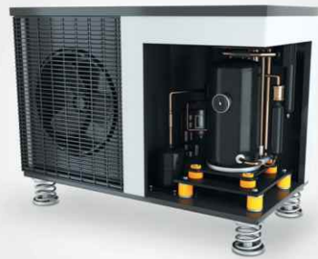
Concept d'isolation de compresseurs avec Sylomer® CGR et Isotop® MSN-DAMP
