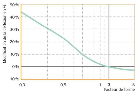
Fig. 6 : Déflexion<sup>5</sup> en fonction du facteur de forme
