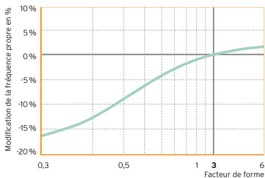
Fig. 8 : Fréquence propre<sup>5</sup> en fonction du facteur de forme
