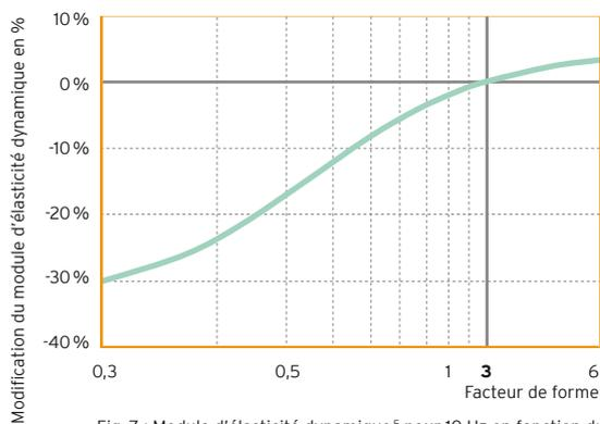
Fig. 7 : Module d'élasticité dynamique<sup>5</sup> pour 10 Hz en fonction du facteur de forme
